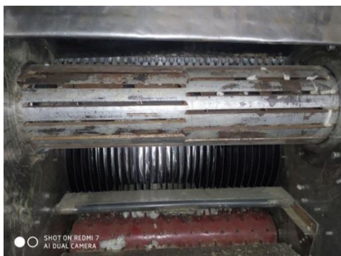
Рис. 1. Вид семяотводящего устройства внутри рабочей камеры
