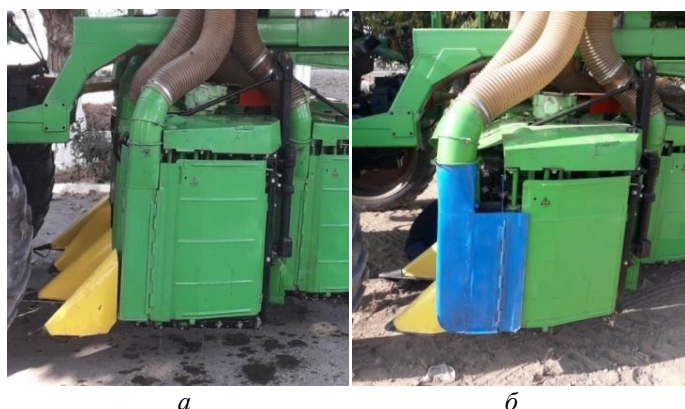
Рис.8. Вертикально-шпиндельные аппараты: а – с серийными камерами; б – новыми приемными камерами
