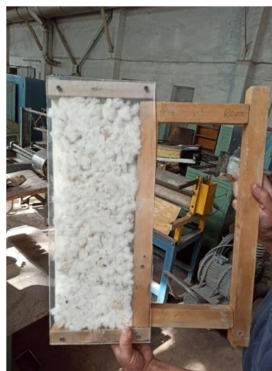
Рис.5. Приспособление для подачи хлопка-сырца в приемную камеру
